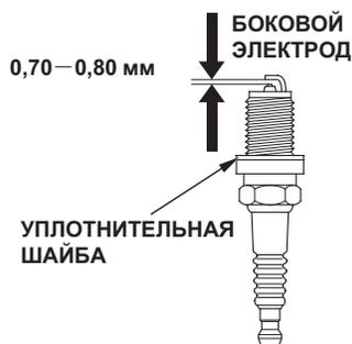
5. Аккуратно установите свечу на место, закручивая вручную, чтобы исключить перекос.
