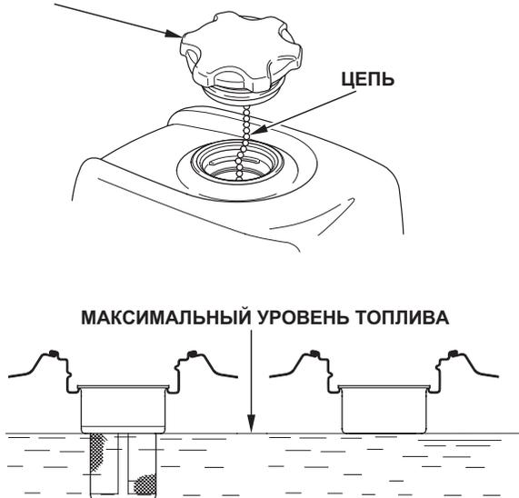
Доливайте осторожно, избегая проливания топлива. Не заполняйте топливный бак до краёв. В зависимости от условий эксплуатации, возможно, уровень заливки топлива потребует снизить. После дозаправки топливом закрутите крышку заливной горловины топливного бака назад до щелчка.
